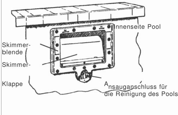
4. Stecken Sie die übrigen Blechschrauben durch die Skimmerblende, die Folie, die Dichtungen, die Wand und die entsprechenden Öffnungen im Skimmer. drehen Sie alle Blechschrauben mit der Hand fest an, damit die Skimmerblende nicht beschädigt wird. Schneiden Sie jetzt mit einem Stanley-Messer die Folie auf der Innenseite der Skimmerblende und ebenfalls bei der Ansaugöffnung weg (Abb. 4).
