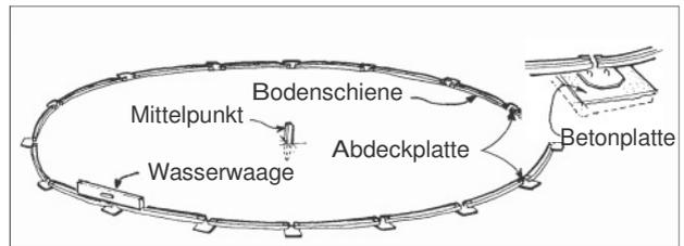
Verwenden Sie einen Pfahl als Mittelpunkt und ziehen Sie einen Kreis mit dem Durchmesser Ihres Pools. befestigen Sie hierfür einen Draht oder eine Schnur am Holzpfahl und auf der anderen Seite an einem Schraubenzieher oder einer
