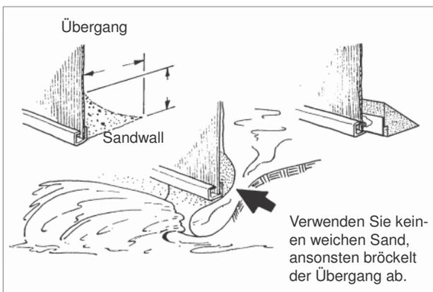
Wichtiger Schritt: bringen Sie an der Innenseite der Stahlwand einen schrägen, nach unten ablaufenden Übergang aus stabilisiertem Sand von ungefähr 15 cm Höhe und Breite an (Mischverhältnis 1m<sup>3</sup> Flusssand mit 1 5 kg Zement). Dieser kleine Wall dient zum Schutz der Innenverkleidung und ist äußerst wichtig. Durch den Wasserdruck kann sonst die Folie unter die Bodenschiene nach außen gedrückt werden.
