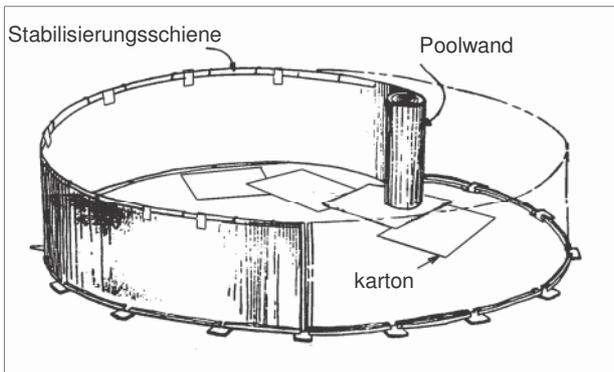
Nehmen Sie jetzt die Stahlwand aus der Verpackung (Pfeil nach oben). der Anfangspunkt der Wandmontage hängt vom Platz für die Pumpe und den Filter ab, da sich Skimmer und Einlauföffnung am Ende der Blechrolle befinden. Beginnen Sie immer in der Mitte eines Schienenverbindungsstücks und rollen Sie dann jeweils 1,5 m ab, die Sie dann in die Rillen der Bodenschiene platzieren. Wenn die beiden Wandenden nicht nahtlos aneinander anschließen, müssen die Bodenschienen in den Verbindungsstücken
