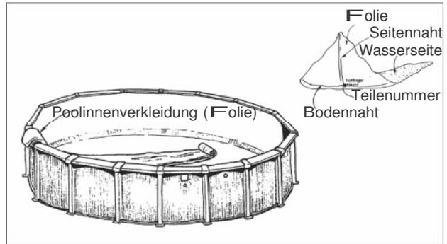
Entfernen Sie den Pfahl in der Mitte und überprüfen Sie den Boden nochmals auf Kies, Glas oder andere spitze Gegenstände. Fußabdrücke und andere Unebenheiten eibnen. Es empfiehlt sich, den Boden zum Schutz der Poolinnenverkleidung mit einer wasserdichten Teppichunterlage zu bedecken, die Sie mit Klebeband an der Unterseite der Stahlwand festkleben können. Platzieren Sie anschließend die Innenverkleidung auf den Randschienen und überprüfen Sie sie entsprechend den Angaben.
